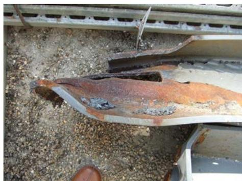
圖 4、柱與梁接頭處翼板受拉挫屈
