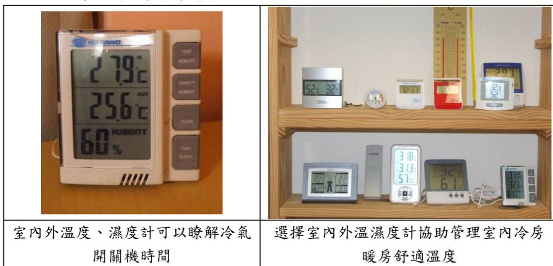
圖19、室內外溫濕度計示意圖
