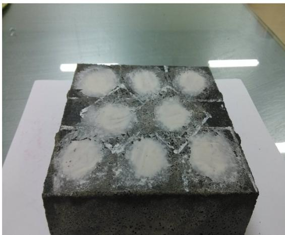
圖九(c)標準砂填補黏土後外觀
