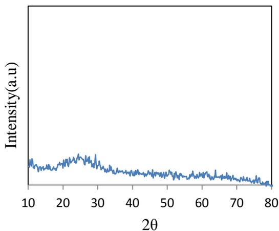
圖一(c) 耐磨砂 XRD 分析圖譜
