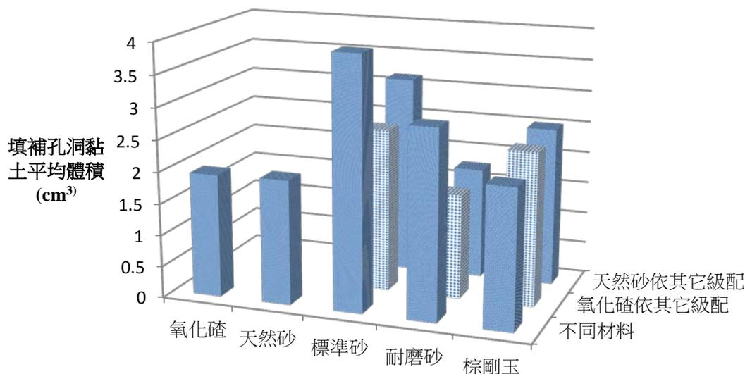
圖十三 不同細骨材與粒徑之耐磨性質比較
