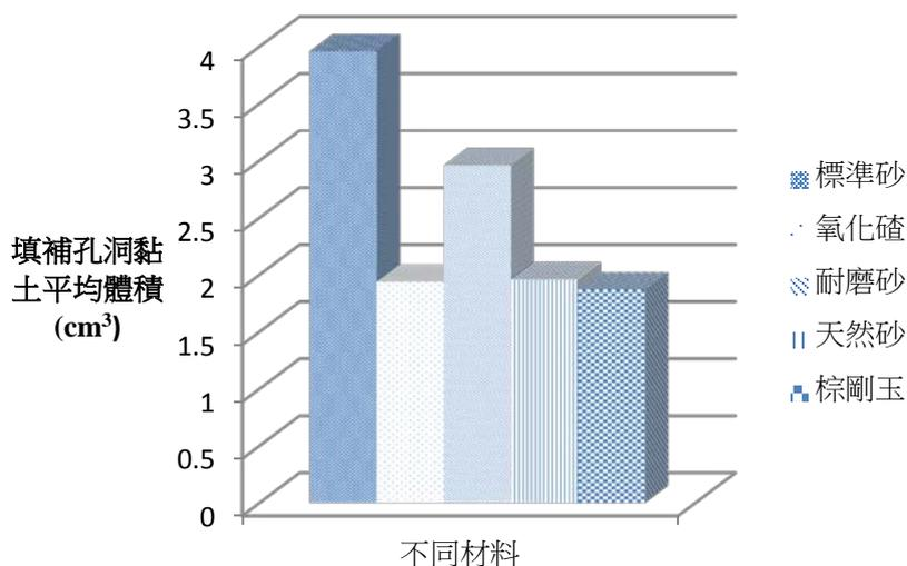
圖十一 不同種類細骨材之耐磨性質比較
