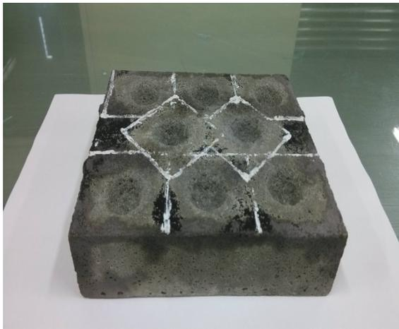
圖九(b)標準砂噴砂後外觀
