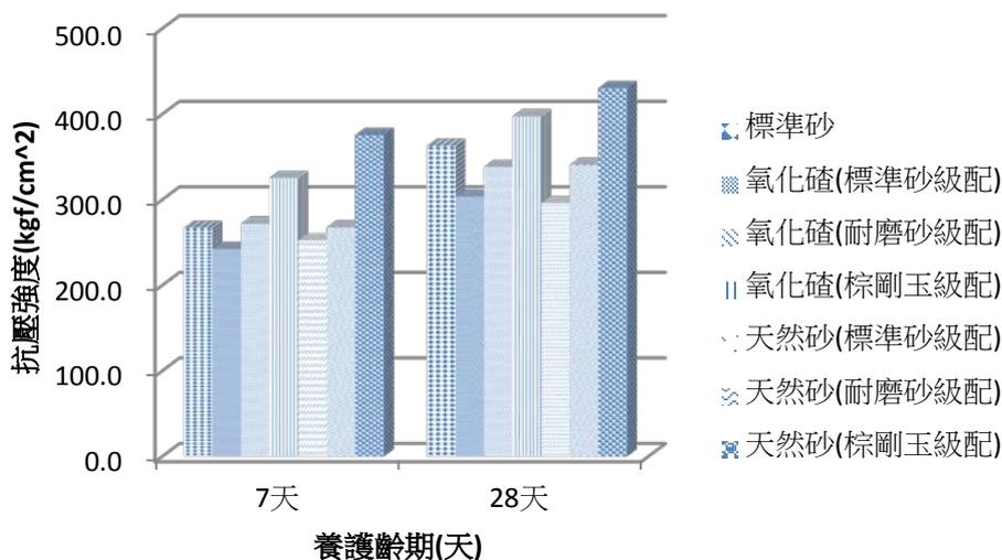
圖八 以氧化矽、天然砂模擬其他三種材料級配(標準砂、耐磨砂、棕剛玉)
