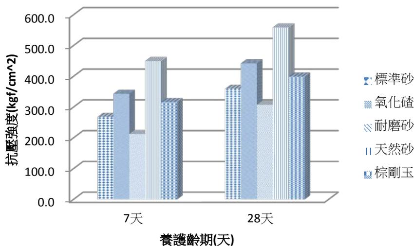
圖七 不同細骨材 7 及 28 天之抗壓強度
