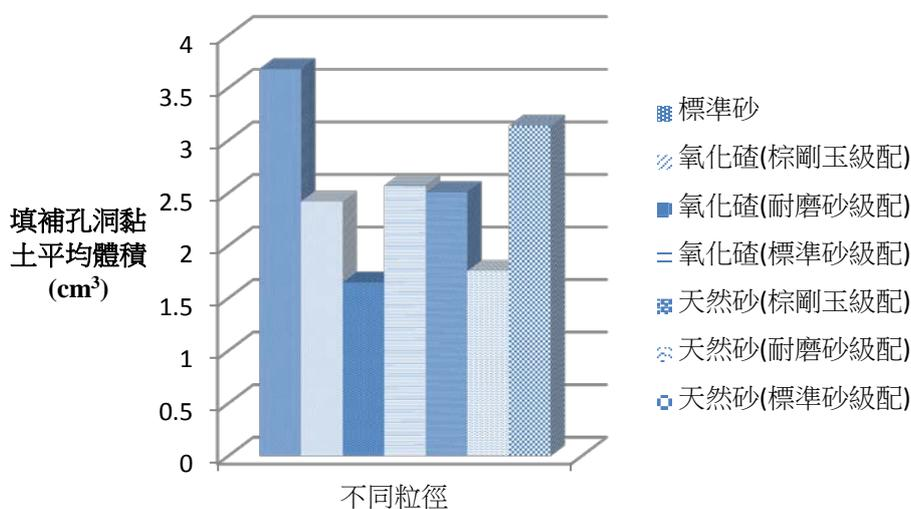
圖十二 不同粒徑細骨材之耐磨性質比較
