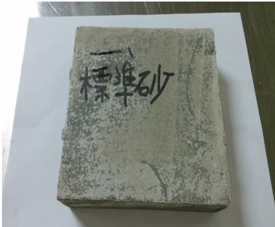
圖九(a)標準砂耐磨平板
